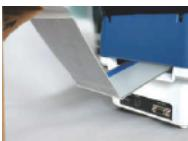
大尺寸的标签在使用中可利用位于打印机后面的入纸口穿入
